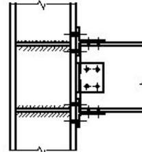
(d) T-sections with preloaded bolts to flanges
